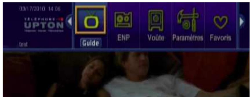
Pour naviguer dans la barre du menu, utilisez les boutons situés à gauche et à droite du bouton **OK**. Pour accéder à une option, sélectionnez un item du menu lorsqu'il est entouré d'un carré jaune et appuyez sur le bouton **OK**. Ceci vous permettra d'accéder à l'option désirée.
