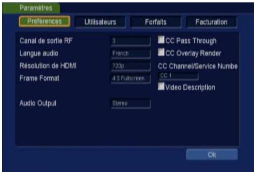
Cette section vous permet de définir le paramètre de la langue, la résolution de l'image, 480 pour un téléviseur standard, et 720 ou 1080 pour les téléviseurs Haute Définition et le format de l'image 4:3 pour un téléviseur standard et 16:9 pour un téléviseur Haute Définition.
